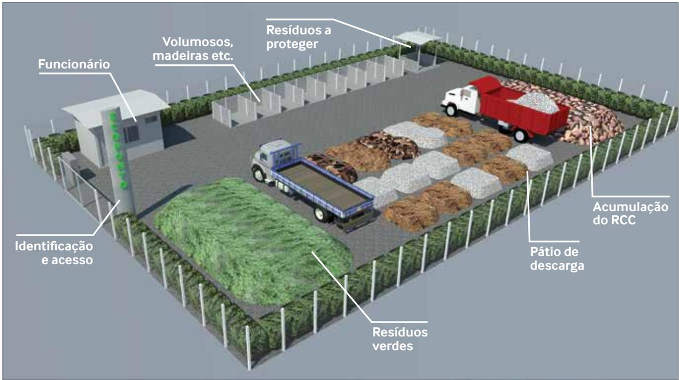
Figura 4 - Desenho ilustrativo do Sistema de Áreas de Manejo
