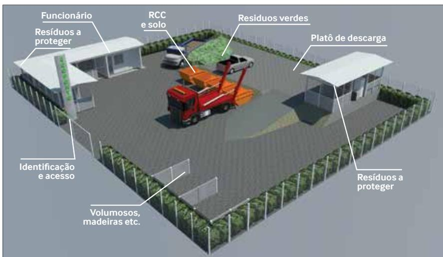
Figura 3 – Desenho ilustrativo do Ecoponto Simplificado – área em torno de 1.000m<sup>2</sup> para manejo do RCC com equipamento de carga
