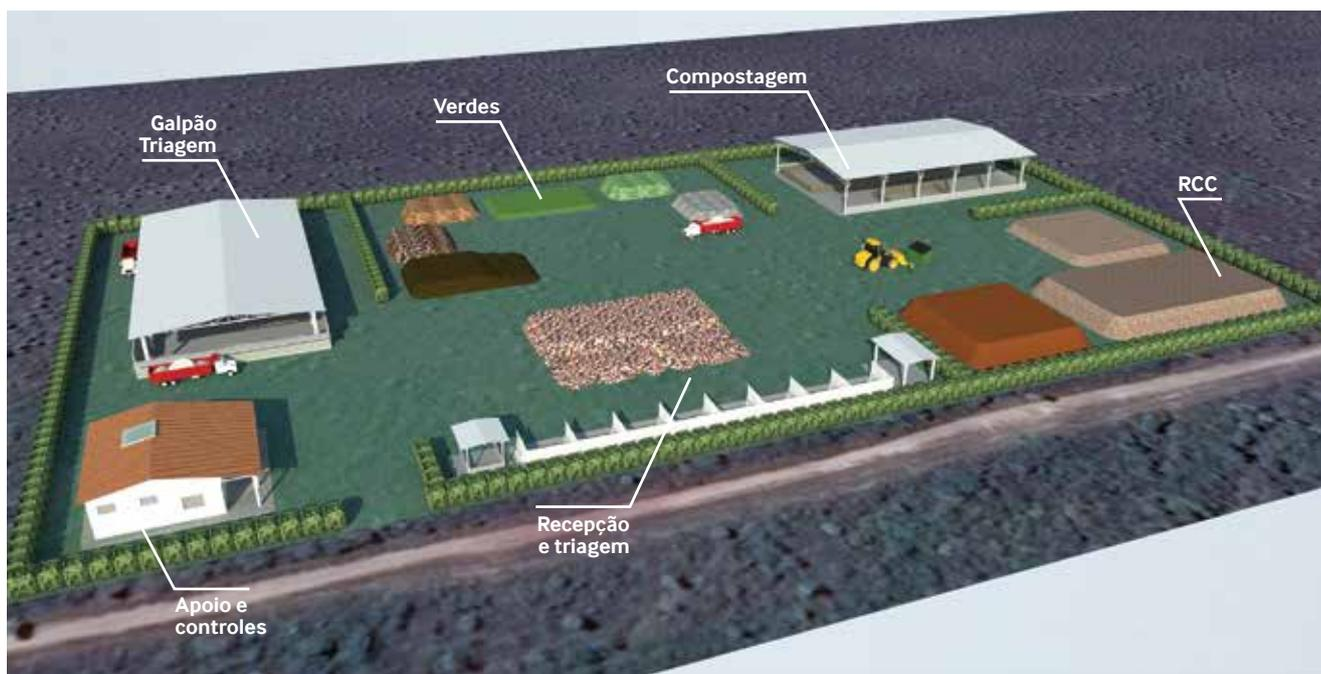
Figura 2 - Desenho ilustrativo de Ecoponto – área em torno de 700m<sup>2</sup> para municípios onde há operação de caminhão poliguindaste
