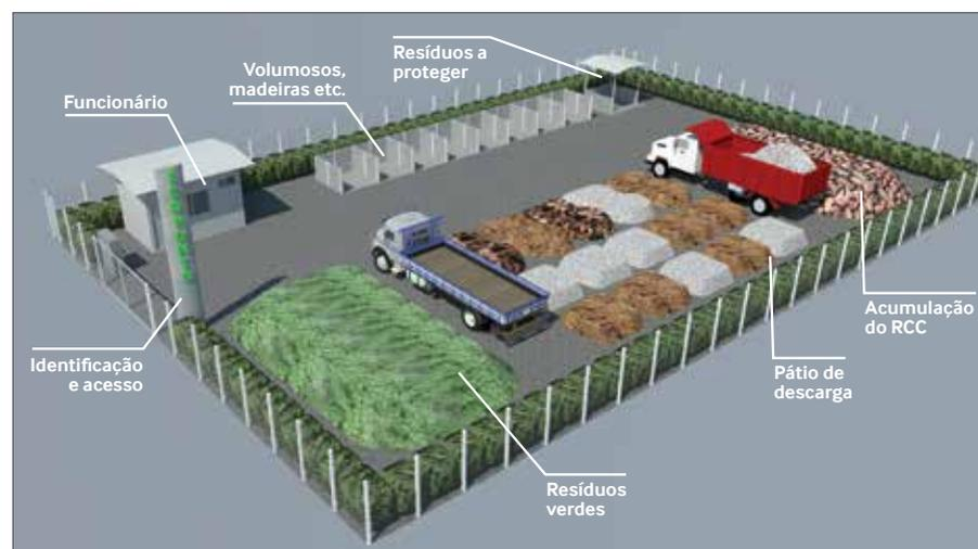
A CMR é uma instalação de múltiplos usos onde ocorrem: a compostagem de resíduos orgânicos; a triagem de resíduos da construção civil e seu peneiramento; o
